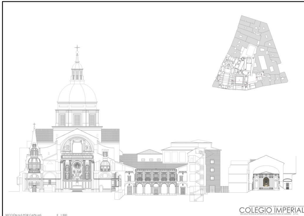
Figura 6. Concatedral e Instituto de San Isidro: sección y alzado transversal.
