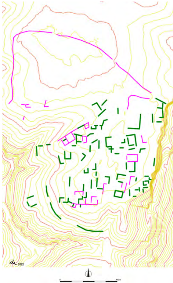
Figura 3. Estructuras identificadas en La Marañosá sobre topográfico (curvado de base MDT-LiDAR: 2016 - PNOA-2016-MAD-452-4460-ORT-CLA-RGB) a partir de la topografía georeferenciada de los restos murarios visibles en superficie (en magenta) y de la lectura espacial de los datos LiDAR (en verde) (Imagen de I. Hortelano)
