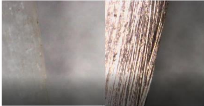
Figura 9. Piezas bajo el microscopio a 0.5 aumentos antes de su uso, pudiéndose observar brillo en el caso del sílex (izquierda) y estrías del pulido en la pieza de cobre (derecha)
