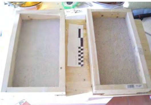
Fig. 7. Molde relleno con mezcla ya repartida homogéneamente fraguando
