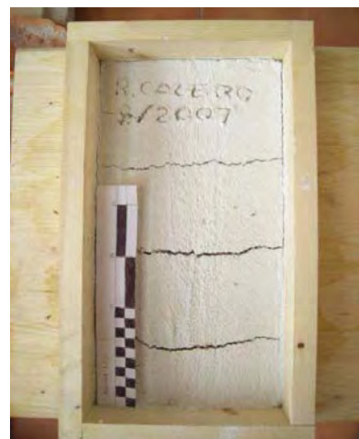
Fig. 8. Pieza de mortero fraguada realizada con cal grasa, arena y agua, donde se pueden observar claramente las fisuras que se han producido
