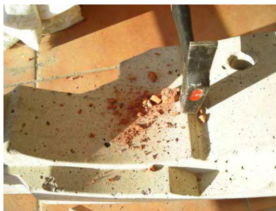
Fig 5. Proceso de machaqueo de la teja sobre piedra
