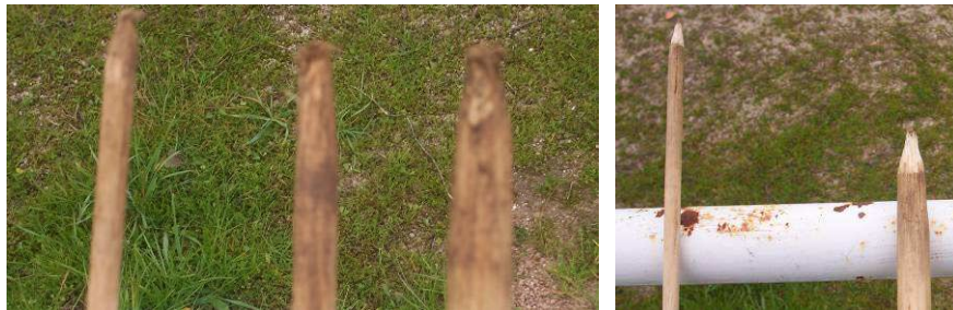
Fig. 10. Detalle de la comparación de puntas desgastadas y recién afiladas
