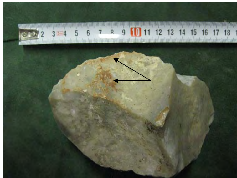
Figura 22: Detalle de los residuos adheridos al cepillar
