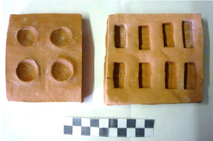
Figura 1. Moldes de arcilla usados para la experimentación.
