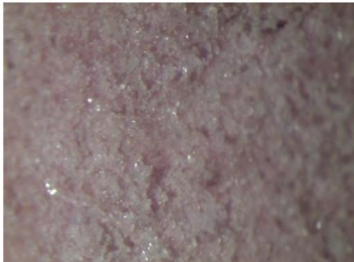
*Figura 4. Momento de la eflorescencia, visto con lupa binocular.*
