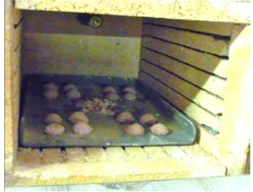
*Figura 5. Momento de introducción de las piezas en el horno para su cocción.*
