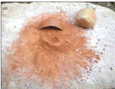
Figura 1: obtención de granos de arcilla cocida (chamota).
