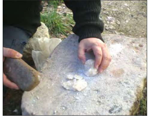
Figura. 2: Calcita machacada para la obtención de granos de diversos tamaños.
