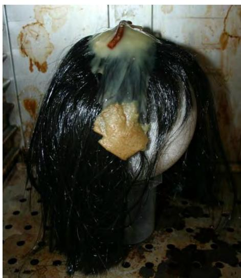
*Figura 10. Detalle del derretido de la parte superior del cono. Se produce un desprendimiento que se desliza por la peluca y se pierde por completo. Elaboración propia.*
