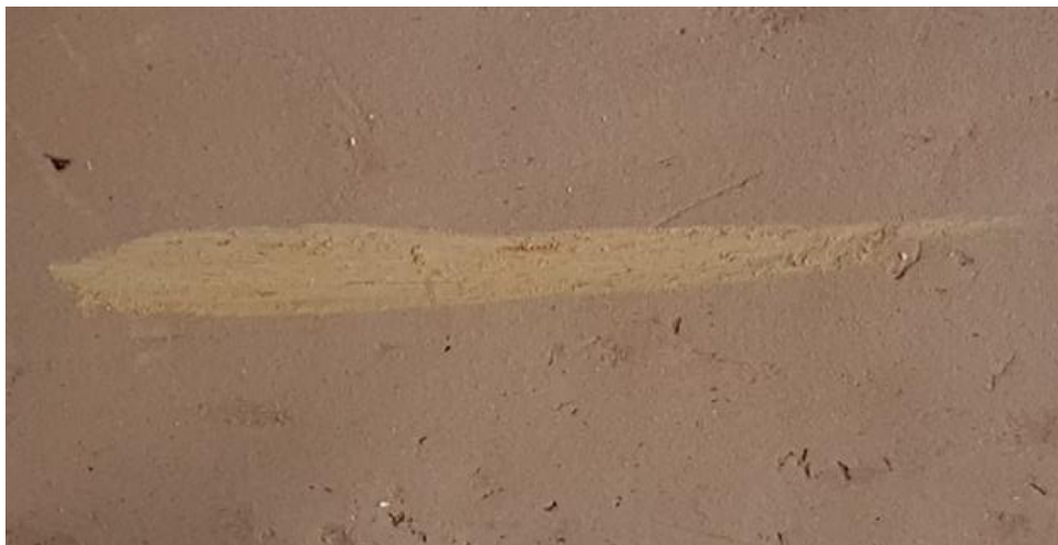
Figura 17. Marca incisa en la hoz al ser rayada con el cuerpo cerámico
