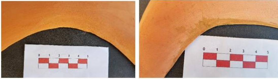
Figura 13. Corte de la hoz (Aula de Cerámica) antes y después de su uso
