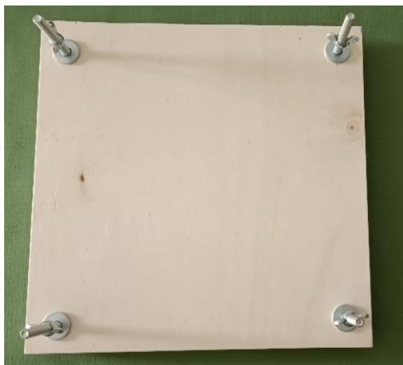
Figura 1: Preparación de la prensa de mano sobre un tablón de madera
