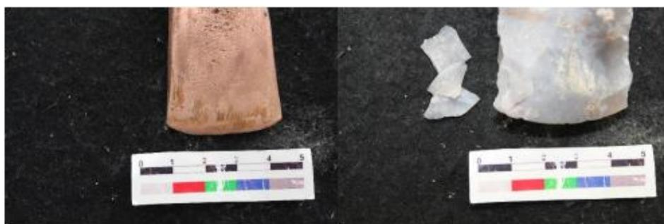
**Figura 8.** Vista macroscópica del estado final de los filos tras los 60 golpes de las pruebas realizadas.
