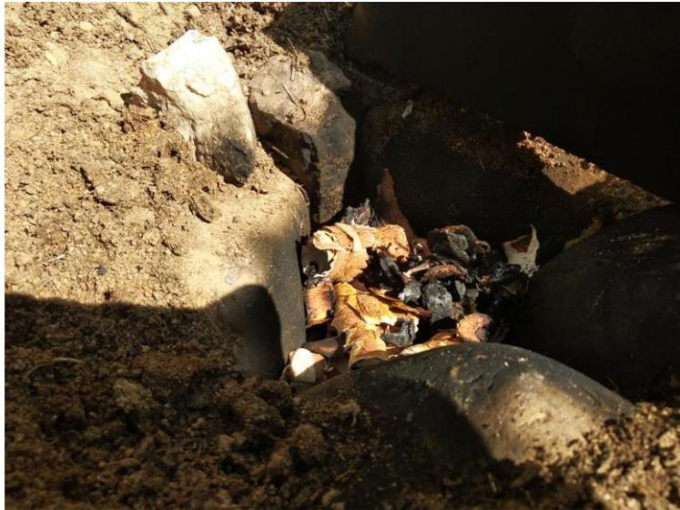
**Figura 2:** Cortezas preparadas para iniciar la pirólisis en la primera experimentación
