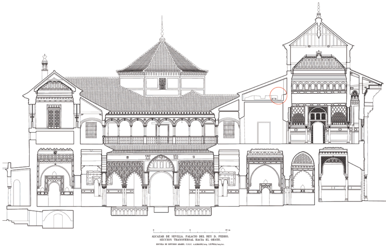
Fig. 9. Sección actual del palacio de Pedro I. El círculo indica dónde se encuentra el resto de yesería y la huella del estribo de la armadura de la sala alargada del piso alto (A. Almagro).
