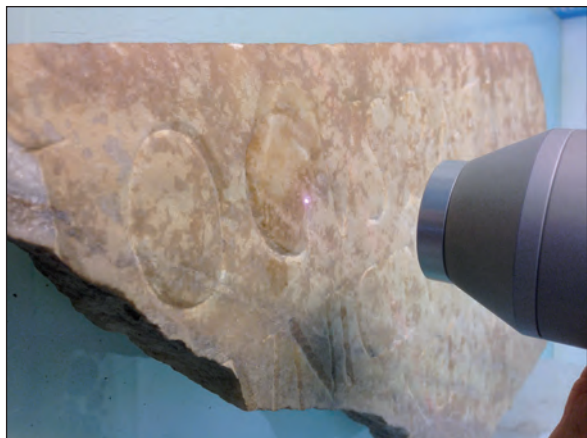
Figura 7. Proceso de limpieza con láser sobre el epígrafe 2.
