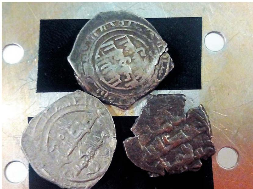
**Figura 4.** En la imagen podemos ver el aspecto final de los tres métodos de limpieza elegidos según la composición y deterioro de las piezas tras el control mediante observación y análisis SEM-EDX. Siguiendo el sentido de las agujas del reloj: moneda de plata con pátina de sulfuros rebajados con Pre-lim en las zonas que evitaban la lectura, moneda en la que predominaba el cobre limpiada mecánicamente y moneda rica en plata sin sulfuros en sus pátinas
