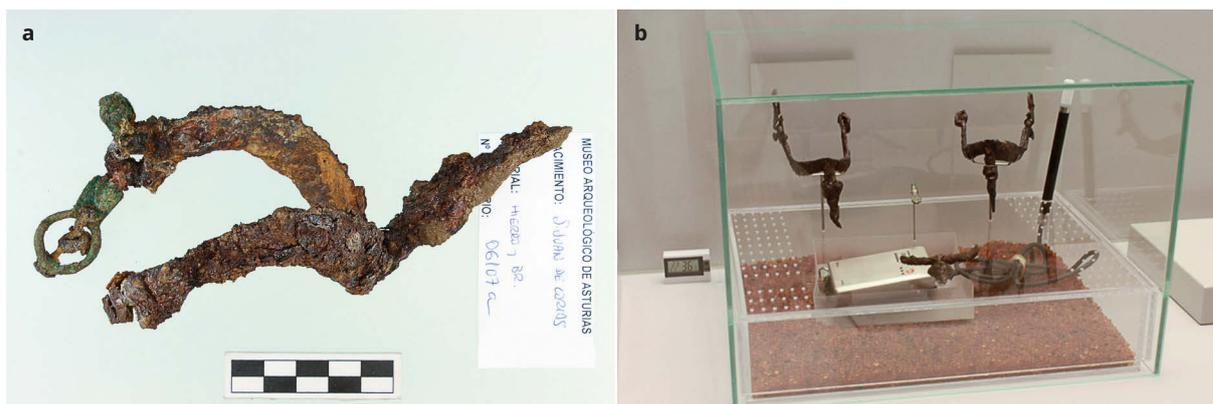
**Figura 3.** a. Espuela del monasterio de Corias antes de la limpieza. b. Sistema de doble vitrina diseñado para la protección de las espuelas, e inclusión temporal de un datalogger para su acondicionamiento ambiental
