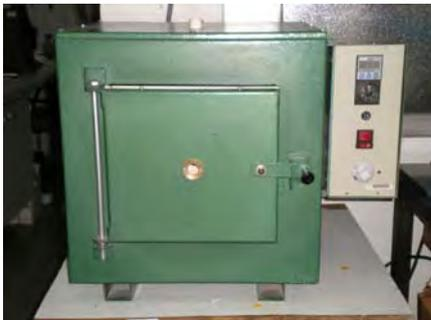
Figura 5. Mufla usada para el tratamiento térmico.
