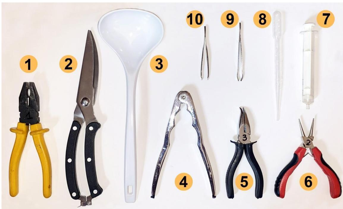
Fig.3. Herramientas para la simulación de los distintos picos. Estas son: 1. Alicata-1, 2. Tijeras, 3. Cuchara sopera, 4. Cascanueces, 5. Alicata 3, 6. Alicata-2, 7. Jeringa, 8. Pipeta, 9. Pinzas-1 y 10. Pinzas-2.
