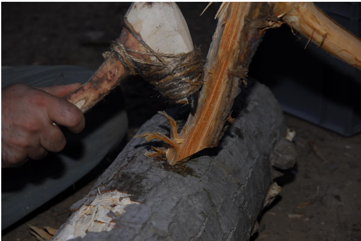
Figura 3. Uso de una azuela para el desbastado de un mango de azuela de pino.
