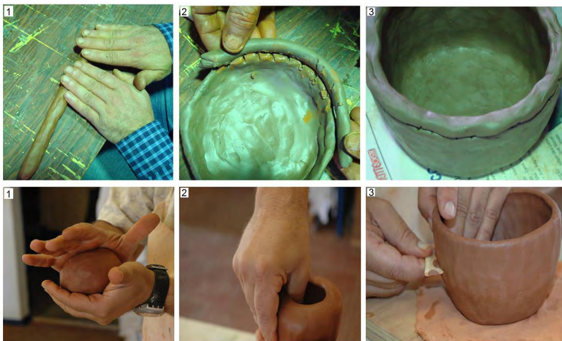
Figura 6. Principales pasos utilizados en la técnica de la bola y de los rollos. Arriba, técnica de los rollos: 1- elaboración de rollos, 2- con un artefacto se hacen cortes en la pared de las piezas y en los rollos y 3- se hace la junción. Abajo, técnica de la bola: 1- batimiento de un pedazo de barro hasta quedar con una forma esférica, 2- con la presión del pulgar se hace un agujero en el centro de la bola y 3- alargamiento del agujero y extensión de las paredes con ayuda de las manos o de un artefacto.
