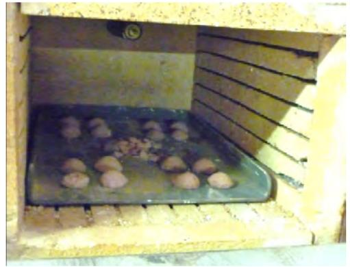
*Figura 5. Momento de introducción de las piezas en el horno para su cocción.*
