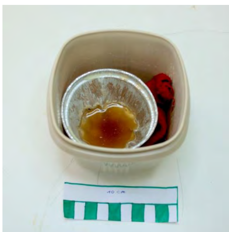
Figura 7. Residuos color oscuro en el fondo del cono. Elaboración propia.
