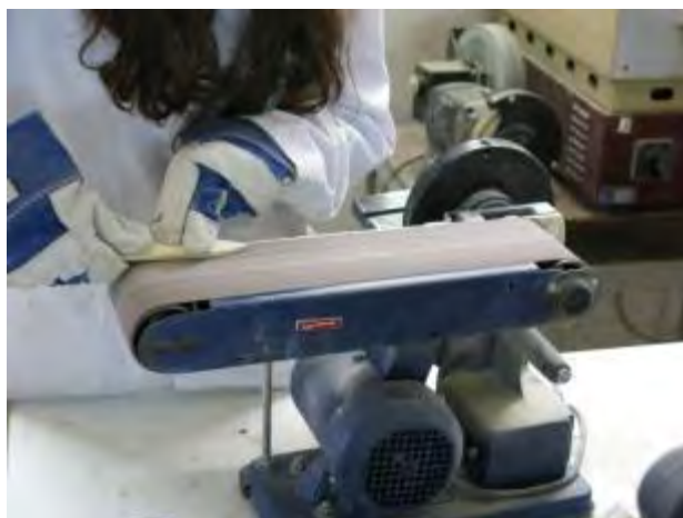
Figura 4: Lijando la bramadera n° 3
