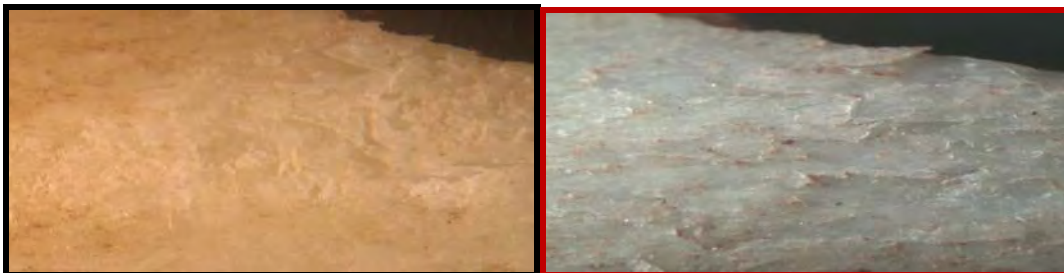
Figura 13. Superficie de la pieza 2.2 previa a la experiencia (izq), y superficie de la pieza 2.2 posterior a la experiencia donde se aprecia la descamación (dcha).
