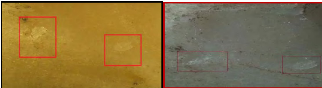
Figuras 7 y 8 .Marcas superficiales que aparecían en la pieza 2.5 antes de realizar la experiencia y marcas superficiales de la pieza 2.5 tras realizar la experiencia.
