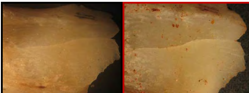
Figura 16. Imagen de la zona de la Pieza 2.3 donde se aprecia la grieta antes de la experiencia (izq.) y después de la experiencia (dcha.).
