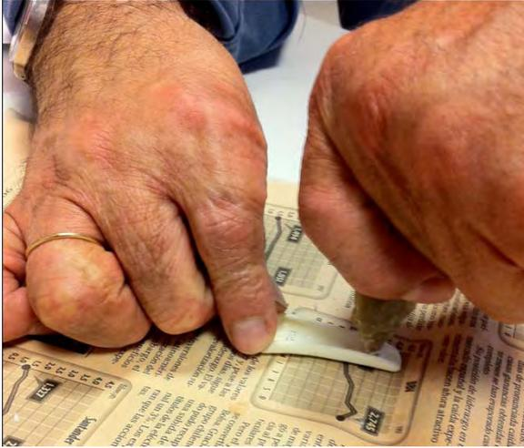
Figura 18. Haciendo el orificio con una punta sin empuñadura.
