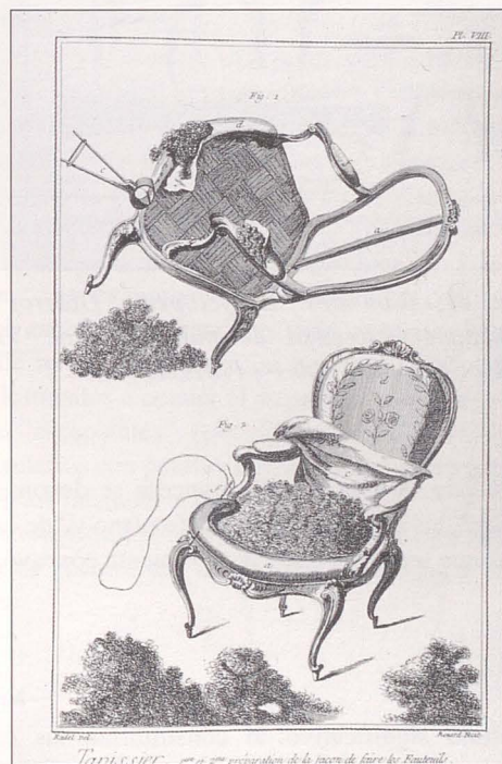
Fig. 13. Silla de brazos durante el proceso de tapizado. Encyclopédie Diderot y D'Alembert. Recueil de planches, vol. IX, "Tapissier", París, 1771.
