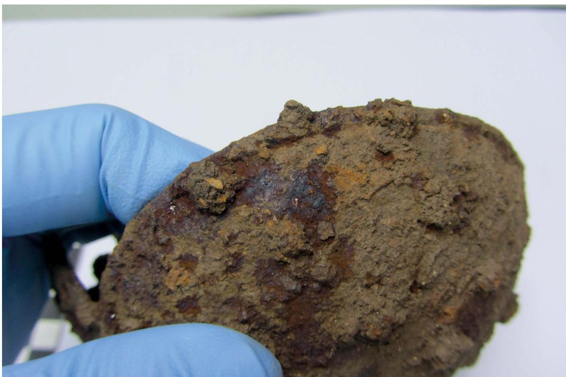
**Figura 3.** Estado inicial del objeto metálico se observan cúmulos terrosos, zonas de oxidación más activa y zonas aisladas de magnetita
